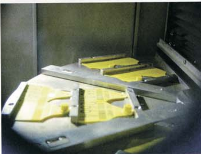
Door de lasertechniek zitten de cijfers in het plastic en niet er op zoals bij verf.
